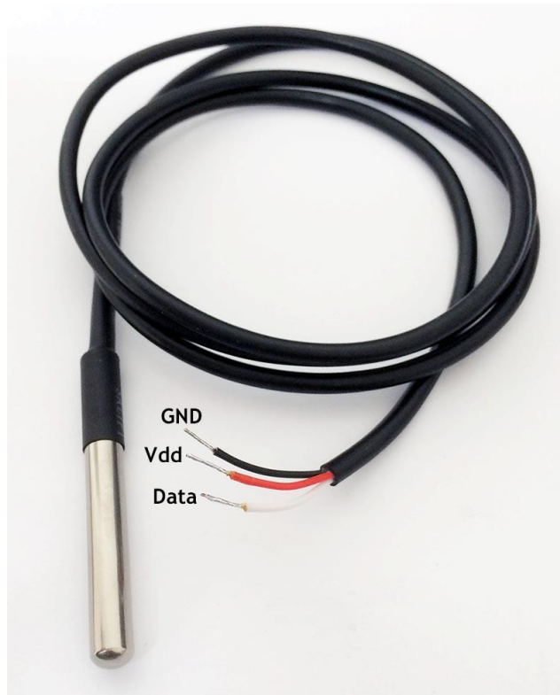
Рисунок 2.16 – давач температури DS18B20 у вологостійкому корпусі Основні характеристики давача:
